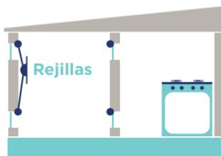
■ Cuando la aireación se logra mediante ductos horizontales que comunican directamente con la atmósfera exterior cada ducto deberá tener un área interior libre de  $11\text{ cm}^2$  por cada kilovatio ( $3,6\text{ Mj/h}$ ) de
